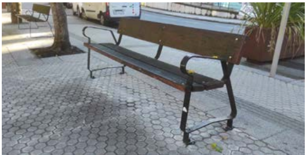
Errazago eseri eta jeikitzeke, eserleku irisgarrien bi albo banatan heldulekuak jartzea eskatzen du araudiak. Horretaz gain, 40-45cm-tako altuera ezartzen du araudiak: normalena da adinekoek 45cm edo gehiagoko altuera eskatzea.
