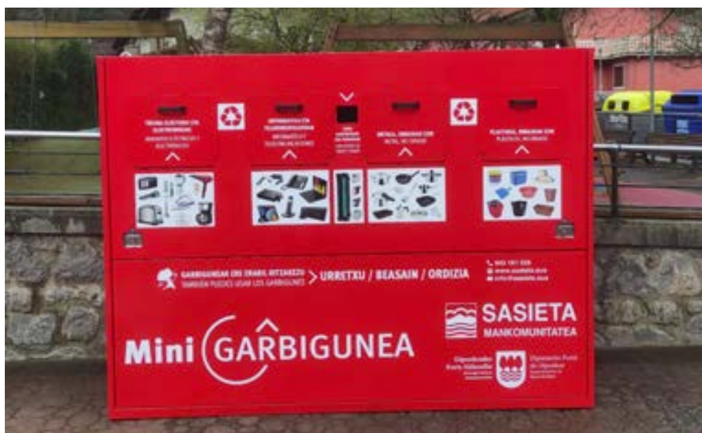
Soraluzeko eta Legorretako mini garbiguneak: ahoen altuera gehiegizkoa da.
