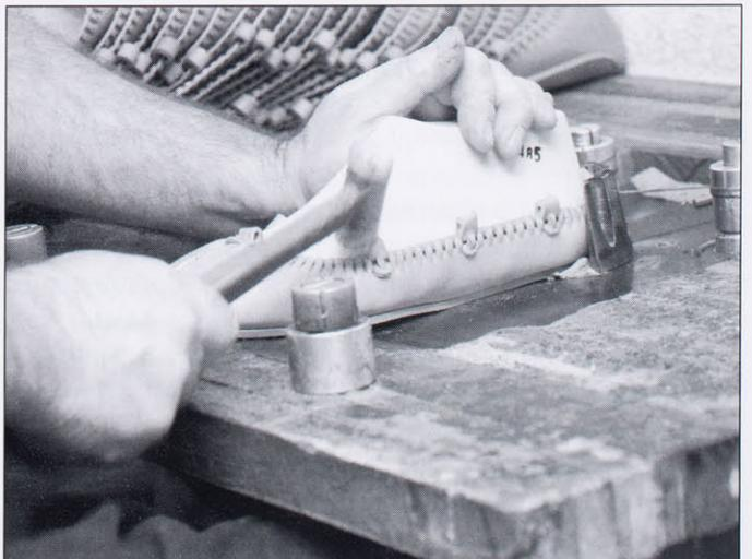
La siguiente operación consiste en rebajar o adelgazar la puntera y el entorno de la pieza. En los casos de coser a mano la parte delantera de la abarca es necesario marcar la costura para lo que utiliza una plantilla y agujerear con un sacabocado la puntera. Se pasa a continuación a colocar la *crepelina* es decir reforzar la abarca para proteger el pie para lo que primeramente se sujeta esta pieza con dos grapas para facilitar, su posterior cosido a máquina.
